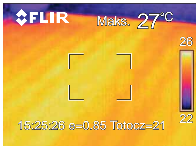
Rozkład temp. podłogi w pomieszczeniu ogrzewanym systemem Wavin Tempower. Zdjęcie z kamery termowizyjnej
